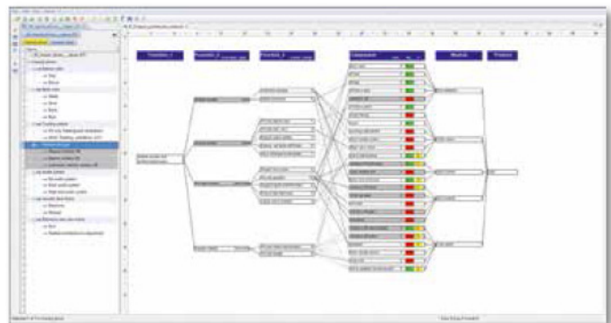
Visualisierung der funktionsorientierten Produktarchitektur mit der Software METUS zur schnellen Entscheidungsfindung im Modularisierungs- und Standardisierungsprozess.
